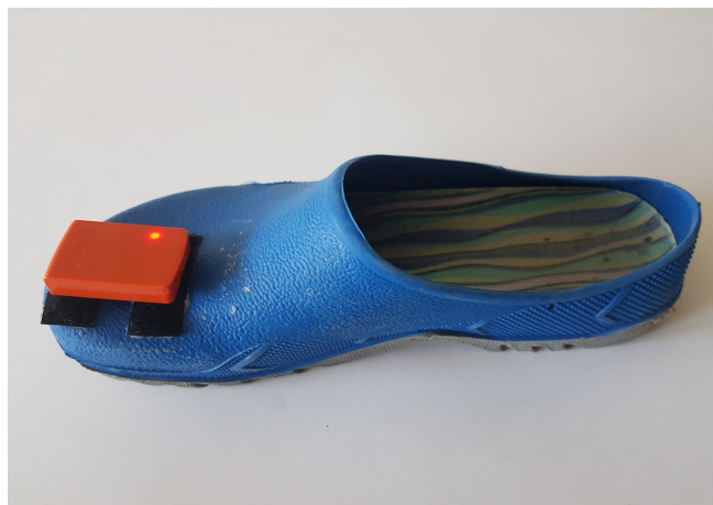
Abbildung 3.6: OP-Schuh mit angebrachtem Inertialsensor.
